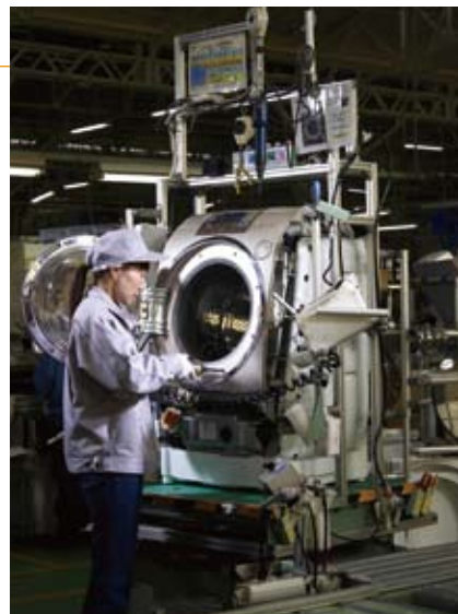
ドラム式洗濯乾燥機のセル生産の様子
