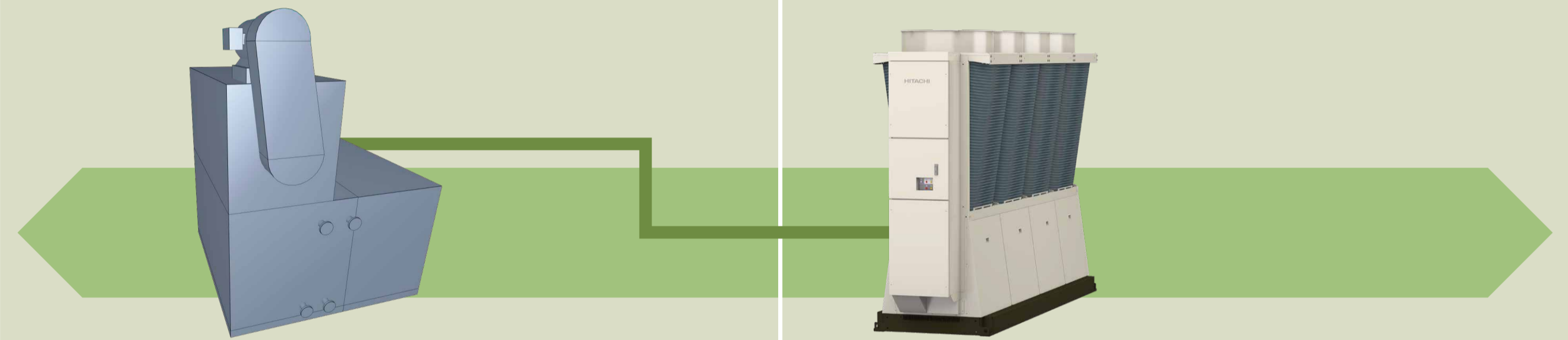
エアハンドリングユニット+チラーユニット
