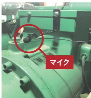
ターミナルボックスにL字金具を固定しL字金具先端にマイクを結束バンドで固定
