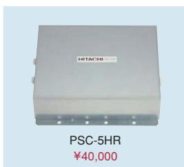
H-LINK総配線長1,000m以上の場合の中継器です。また、H-LINK上の機器の責任分担を明確化するため、この中継器を介して接続することができます。なお終端抵抗の設定は、中継器の前後に必要となります。
