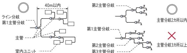
(注) 主管分岐は、分岐後の配管が共にマルチキットへ接続となる分岐方法を示します。
