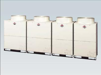
(注) 本図は室外ユニット間隙間20mmの場合を示します。防雪フード取り付けを想定した場合、室外ユニット間隙間は50mm以上としてください。
