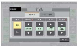
グループやブロックのアイコンを押すと設定画面を表示。部屋ごとの運転・停止、運転モード、手元リモコン操作禁止など各種設定ができます。
