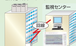
空調機遠隔監視システム
