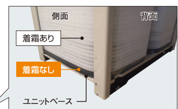
外気温度: 2℃(乾球)/1℃(湿球)の暖房運転時。製造元の恒温試験室にて撮影。
