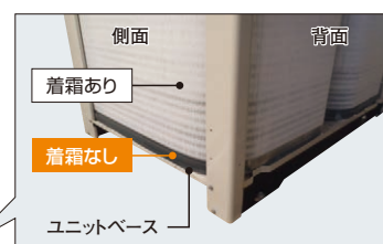
外気温度: 2℃(乾球)/1℃(湿球)の暖房運転時。製造元の恒温試験室にて撮影。
