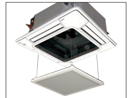
グリル固定部を90°ひねりワイヤーから簡単に取り外して水洗いできます。
