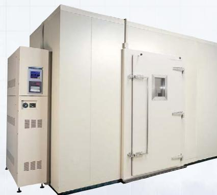
試験室床面積 6.5m<sup>2</sup>(2.0坪)・9.7m<sup>2</sup>(3.0坪)・16.2m<sup>2</sup>(5.0坪)
