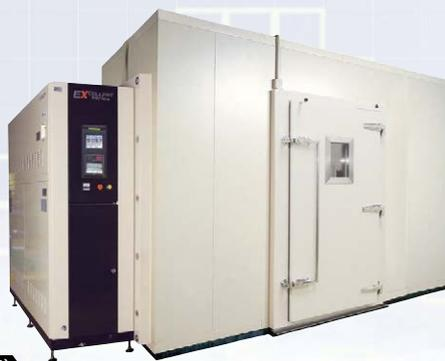
試験室床面積 6.5m<sup>2</sup>(2.0坪)・9.7m<sup>2</sup>(3.0坪)・16.2m<sup>2</sup>(5.0坪)
