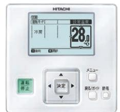
●フルドット液晶の採用により、数字・文字・マークが読み取りやすくなり、運転・操作状態がひと目でわかります。
