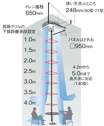
※昇降グリルの下降距離はワイヤードリモコンにより設定可能。レイアウト変更により下降距離を変更する場合でも本体の設定変更がなく調立が不要です。
