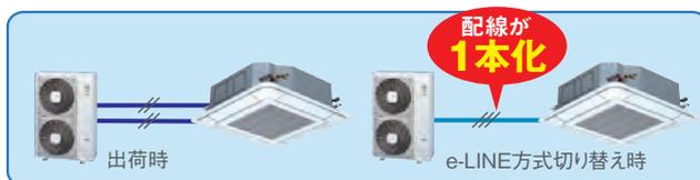
電源線、制御線兼用方式のe-LINE方式に切り替えることにより、室内外ユニット間の配線本数を1本化(3芯線(ヒーターレス時))ができます。(切り替えスイッチは、室内外とも切り替えてください。)
