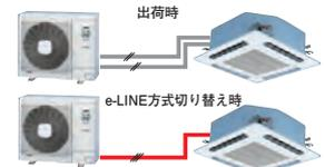
●同時ツイン・トリプル機のワイヤードリモコンの渡り配線を不要としました。(下図はe-LINE方式時)
