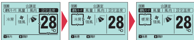
①現在の運転状態 ②左右ボタン(◀▶)で項目を選択 ③上下ボタン(▲▼)で設定を変更
