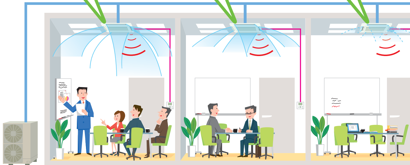
イメージ図(実際の据え付けには、別途分岐管が必要になります。)
