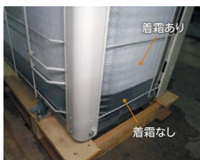
外気温度2℃(乾球)/1℃(湿球)の暖房運転時当社試験室で撮影
