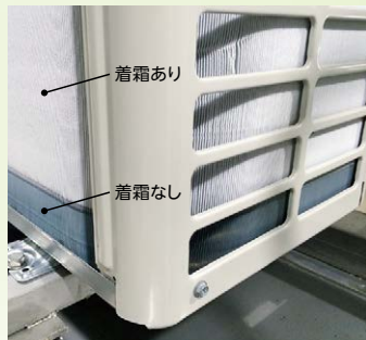
外気温度2℃(乾球) / 1℃(湿球)の暖房運転時。当社試験室で撮影。
