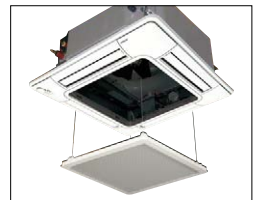
グリル固定部を90°ひねりワイヤーから簡単に取り外して水洗いができます。
