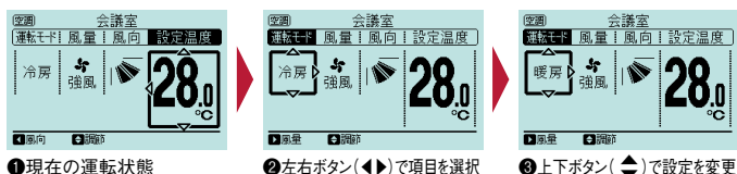
①現在の運転状態 ②左右ボタン(◀▶)で項目を選択 ③上下ボタン(◀▶)で設定を変更
