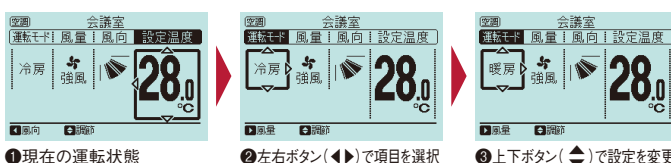
①現在の運転状態 ②左右ボタン(◀▶)で項目を選択 ③上下ボタン(▲▼)で設定を変更
