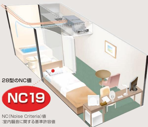
(注1) 吹出口は角ダクト接続(グラスウールダクト施工)し、機外静圧設定は低静圧設定、リモコン設定は冷房弱風設定した場合の28型のNC値を示しています。
