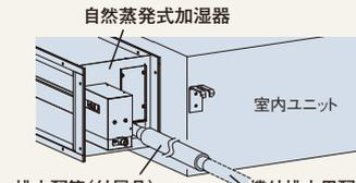
排水配管(付属品) 機外排水用配管
