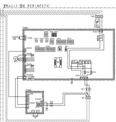
(注)1. 図中破線部分は、現地工事区分を示します。
