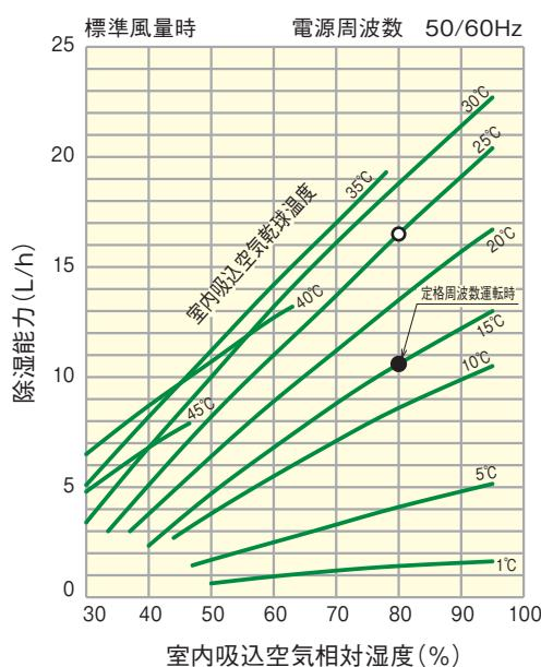
(注)1. 本図は上記容量の除湿機用インバーターユニットが最大周波数で運転した場合の値を示します。図中●は標準条件(吸込空気乾球温度25°C、相対湿度80%)において運転した場合の最大能力を示します。
