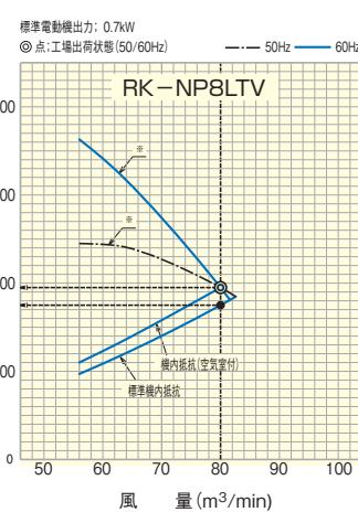
\*RK-NP8LTは、モータ直結駆動式のため機外静圧の値によって風量が特性曲線(\*)上で変化します。※以外の風量、静圧でご使用いただく場合は高静圧改造が必要です。
