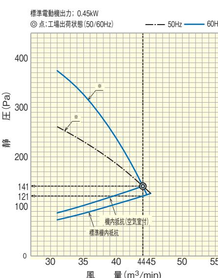
(注)RK-NP4LV1は、モータ直結駆動式のため機外静圧の値によって風量が特性曲線(※)上で変化します。※以外の風量、静圧でご使用いただく場合は高静圧改造が必要です。
