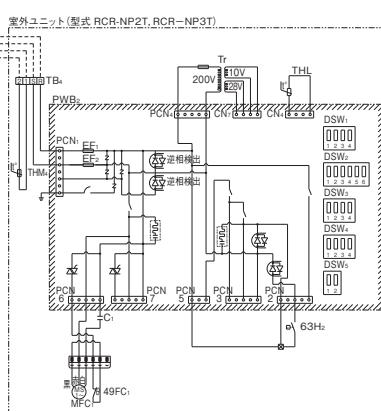
(注)1. 図中破線部分は、現地工事区分を示します。
