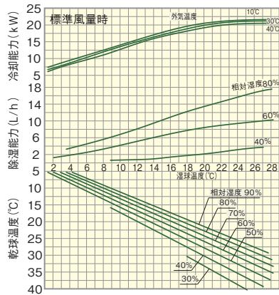
※本図は、室内外ユニット間の冷媒配管長さを片道水平5mとし、運転した場合を示します。
