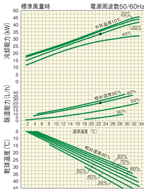
(注)1. 本図は上記容量の除湿機用インバータユニットが最大周波数で運転した場合の値を示します。図中●は標準条件(吸込空気乾球温度25℃、相対湿度80%、外気温度30℃)において運転した場合の最大能力を示します。
