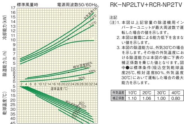
除濕能力特性曲線(再熱運轉時)
