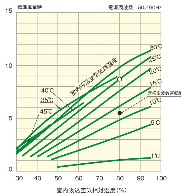
(注)1. 本図は上記容量の除湿機用インバータユニットが最大周波数で運転した場合の値を示します。図中○は標準条件(吸込空気乾球温度25°C、相対湿度80%)において運転した場合の最大能力を示します。
