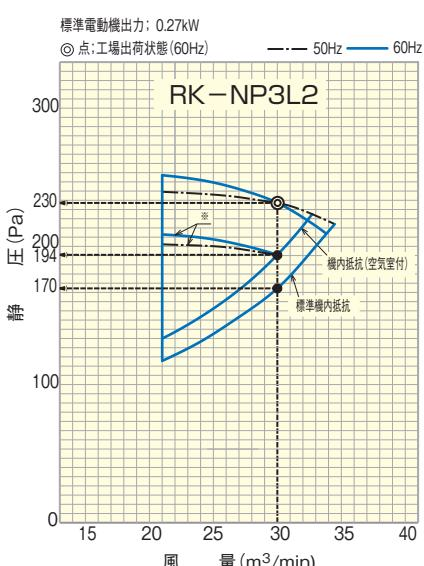
(注)※は別売のプレナムチャンバー(型式:K-2PC)またはダクトボックス(型式:K-2DC1)に付属のコードにより、送風機回転数を調整した場合を示します。
