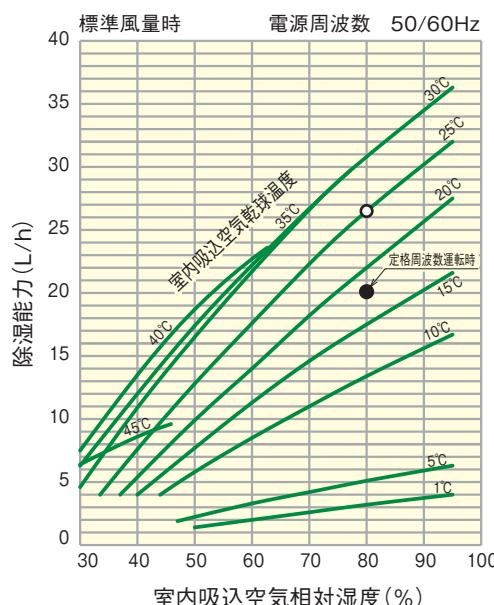
(注)1. 本図は上記容量の除湿機用インバータユニットが最大周波数で運転した場合の値を示します。図中●は標準条件(吸込空気乾球温度25℃、相対湿度80%)において運転した場合の最大能力を示します。
