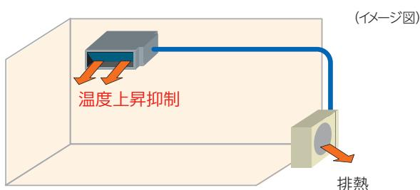
再熱運転時、吹出空気温度は吸込空気温度より、±5°C変化します。
