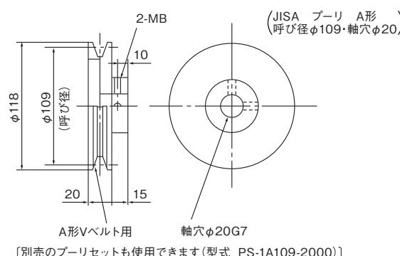
(注)1. 丸ダクト接続用(K-5DC1)を電源周波数50Hzで使用する場合は、図Bを参照のうえ現地にてファンブーリ、Vベルトを準備してください(ビニールダクト使用時のみ)。
