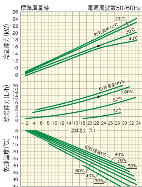
(注)1. 本図は上記容量の除湿機用インバーターユニットが最大周波数で運転した場合の値を示します。図中●は標準条件(吸込空気乾球温度25°C、相対湿度80%、外気温度30°C)において運転した場合の最大能力を示します。
