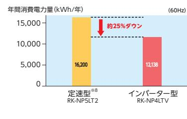
【試算方法】・倉庫内空気条件に応じて除湿能力・消費電力・排熱量・インバーター周波数を計算し、電力量と倉庫内の温湿度変化を3分ごとに計算。
