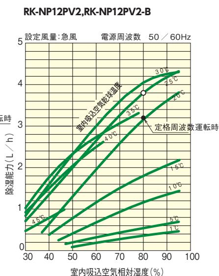
(注) 1.本図は上記容量の除湿機用インバータユニットが最大周波数で運転した場合の値を示します。図中○は標準条件(吸込空気乾球温度25℃、相対湿度80%)において運転した場合の最大能力を示します。
