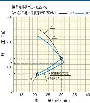
(注)1. RK-NP2L(T)Vは、モータ直結駆動式のため機外静圧の値によって風量が特性曲線(※1)上で変化します。
