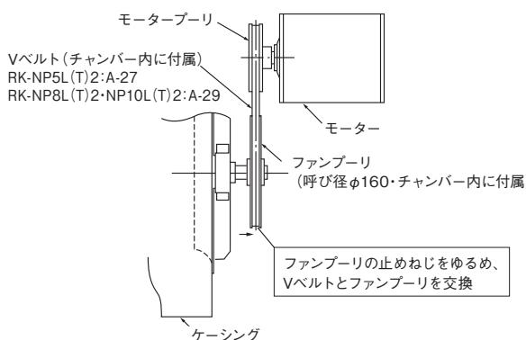
図B K-5DC1取付時(50Hz)用ファンブーリ詳細図
