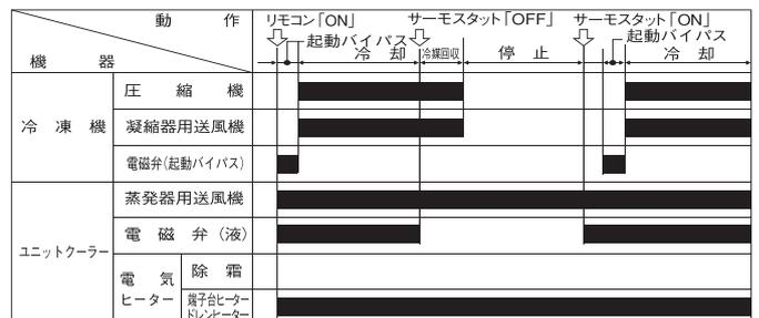
注 (1) 本図は空冷式冷凍機の場合を示します。 (2) ■印は「ON」を示します。
