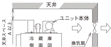
注) 天井スペースは Amm 以上、庫外(凝縮器吸込空気) 温度の限界は 43°Cです。32°Cを超える場合は必ず換気扇を設置し、常時換気してください。
