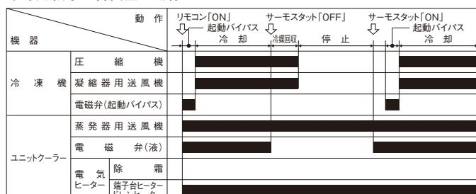
注(1) 本図は空冷式冷凍機の場合を示します。 (2) ■印は「ON」を示します。
