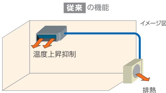
再熱運転時、吹出空気温度は吸込空気温度より、±5℃変化します
