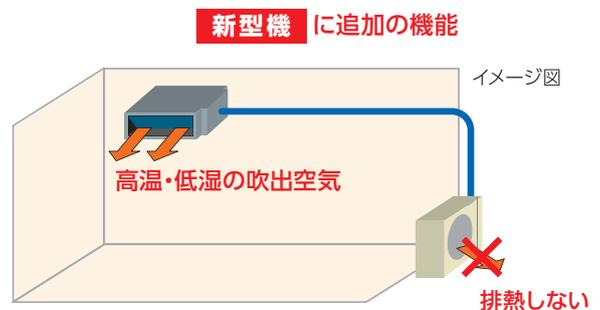
吹出空気温度は、吸込空気温度より約10~25℃上昇します。
