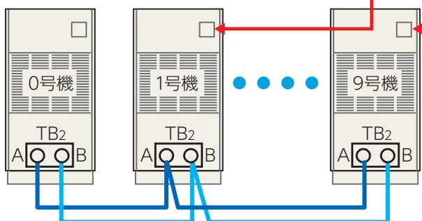
1~9号機の操作パネルと端子台(TB2)を接続している配線を取り外してください。
