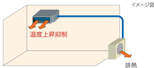
再熱運転時、吹出空気温度は吸込空気温度より、±5℃変化します。
