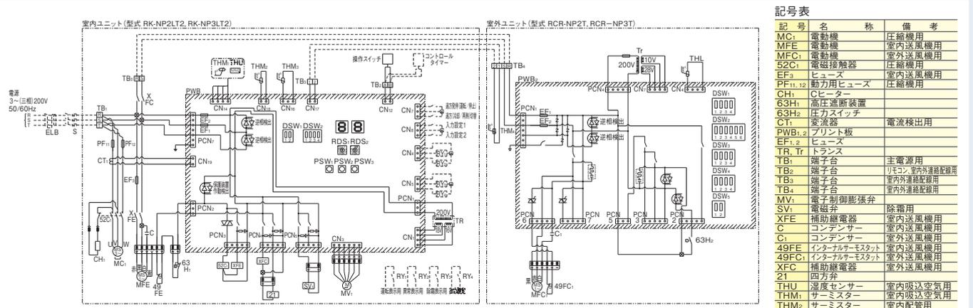
1. 図中破線部分は、現地工事区分を示します。
