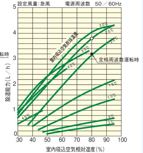
(注) 1. 本図は上記容量の除湿機用インバーターユニットが最大周波数で運転した場合の値を示します。図中○は標準条件(吸込空気乾球温度25℃、相対湿度80%)において運転した場合の最大能力を示します。
