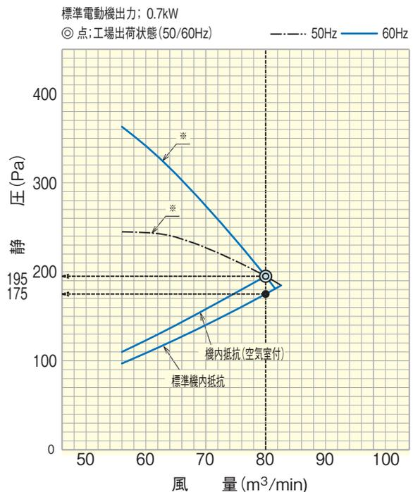
(注) RK-NP8LV1は、モータ直結駆動式のため機外静圧の値によって風量が特性曲線(\*)上で変化します。\*以外の風量、静圧でご使用いただく場合は高静圧改造が必要です。
