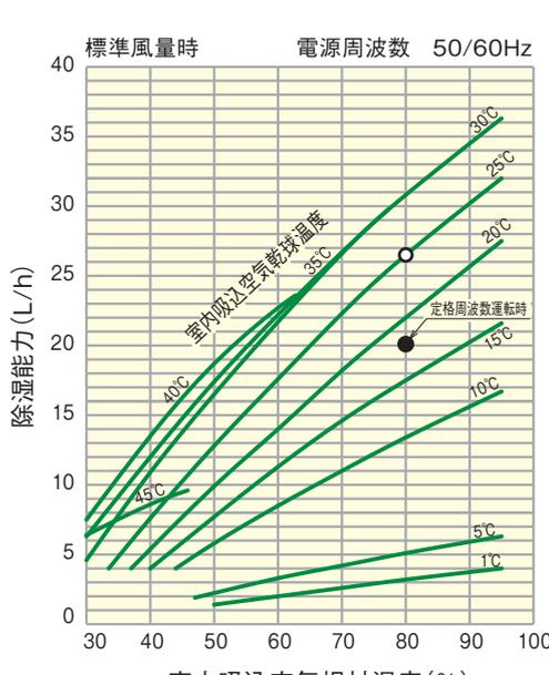
(注) 1. 本図は上記容量の除湿機用インバーターユニットが最大周波数で運転した場合の値を示します。図中○は標準条件(吸込空気乾燥温度25°C、相対湿度80%)において運転した場合の最大能力を示します。
