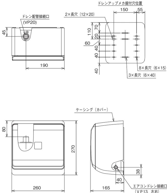
1. 本ドレンアップメカは、日立除湿機に装着して使用するものです。ドレンアップメカ以外の詳細寸法は、各寸法図を参照してください。
