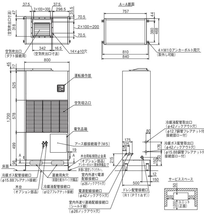
室内ユニットプレナムチャンバー(オプション部品)付寸法図 (単位:mm)
