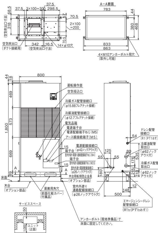
室内ユニットプレナムチャンバー(オプション部品)付寸法図 (単位:mm)
