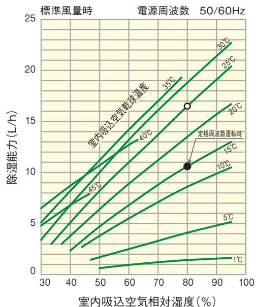
1. 本図は上記容量の除湿機用インバーターユニットが最大周波数で運転した場合の値を示します。図中○は標準条件(吸込空気乾球温度25°C、相対湿度80%)において運転した場合の最大能力を示します。
