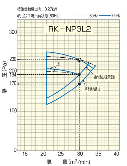
(注) ※は別売のプレナムチャンバー (型式: K-2PC) またはダクトボックス (型式: K-2DC1) に付属のコードにより、送風機回転数を調整した場合を示します。
