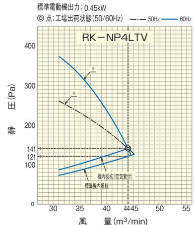
※RK-NP4LTVは、モーター直結駆動式のため機外静圧の値によって風量が特性曲線(※)上で変化します。※以外の風量、静圧でご使用いただく場合は高静圧改造が必要です。
