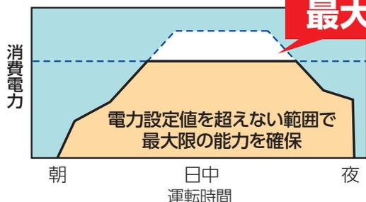
電力設定値を超える範囲の消費電力をカットし、**最大電力を抑制!**
