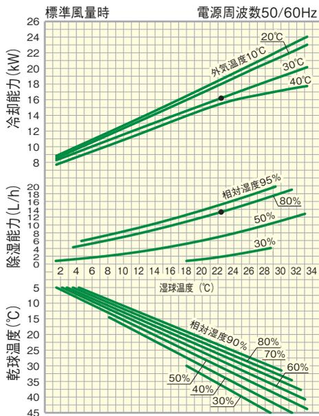
1. 本図は上記容量の除湿機用インバーターユニットが最大周波数で運転した場合の値を示します。図中●は標準条件(吸込空気乾球温度25°C、相対湿度80%、外気温度30°C)において運転した場合の最大能力を示します。
