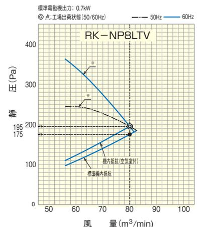
※RK-NP8LTVは、モータ直結駆動式のため機外静圧の値によって風量が特性曲線(※)上で変化します。※以外の風量、静圧でご使用いただく場合は高静圧改造が必要です。
