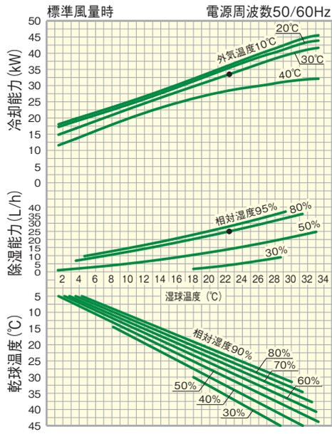
(注) 1. 本図は上記容量の除湿機用インバーターユニットが最大周波数で運転した場合の値を示します。図中●は標準条件(吸込空気乾燥温度25°C、相対湿度80%、外気温30°C)において運転した場合の最大能力を示します。
