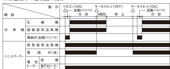
(注)1.本図は空冷式冷凍機の場合を示します。(注)2.■印は「ON」を示します。
