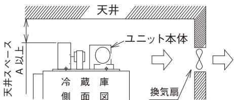
(注) 天井スペースは Amm 以上、庫外(凝縮器吸い込み空気) 温度の限界は 43°Cです。32°Cを超える場合は必ず換気扇を設置し、常時換気してください。
