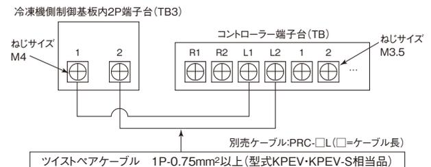
(2)冷凍機とコントローラーの「伝送制御有」の設定
