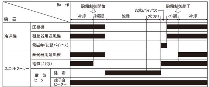
(注)1. 本図は空冷式冷凍機の場合を示します。(注)2. ■印は「ON」を示します。
