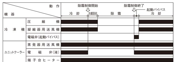
(注) 1. 本図は空冷式冷凍機の場合を示します。(注) 2. ■印は「ON」を示します。
