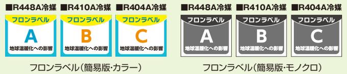
このフロンラベルはフロン排出抑制法に基づく指定製品の環境影響度として用いられている地球温暖化係数(GWP)について、定められた目標への達成度を表したもので、製品を選択するときの参考にしてください。コンデンシングユニット(冷凍機)は、出荷台数で加重平均した地球温暖化係数(GWP)の値が目標年度(2025年度)において、目標値(1,500)を上回らないことが製造事業者などに義務付けられています。
