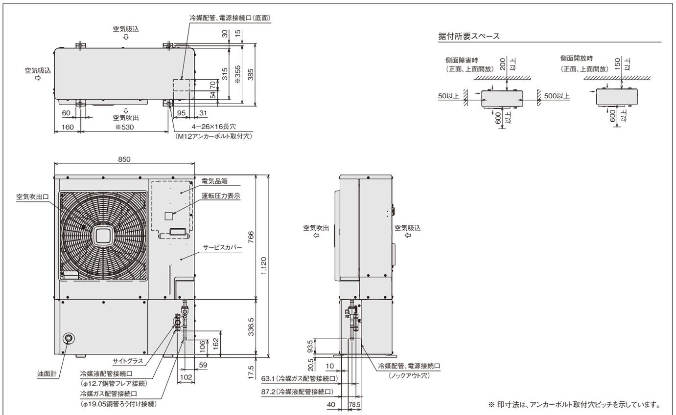
\* 印寸法は、アンカーボルト取付穴ピッチを示しています。
