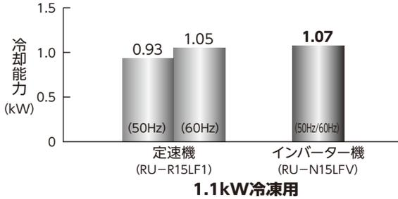
※3 測定条件 最大冷却能力は、冷蔵用は庫内設定温度0℃、冷凍用は庫内設定温度-20℃、庫外温度32℃で蒸発器が無着霜時、最大周波数で運転した場合を示します。
