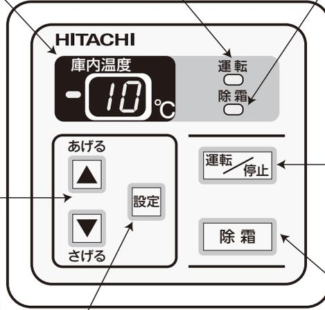
(注) 警報：警報(高温・低温・フィルター警報)が発生すると、庫内温度と警報コードを交互表示しながら、運転を継続します。
