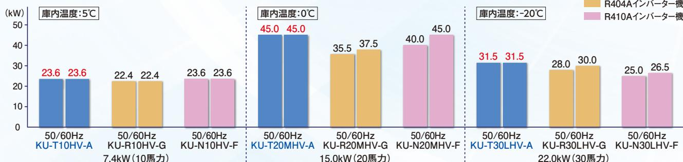
※5.運転条件は外気(凝縮器吸込空気)温度32℃、定格運転時、冷媒配管長(水平片道)5mで無着霜の場合。
