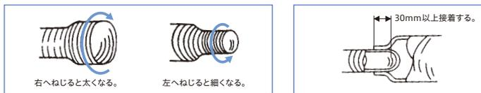
PP(ポリプロピレン)樹脂製ダクトを接着する際は、PP(ポリプロピレン)樹脂の接着に適したものを使用してください。
