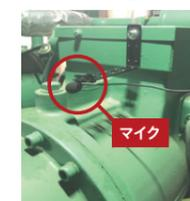
ターミナルボックスにL字金具を固定しL字金具先端にマイクを結束バンドで固定
