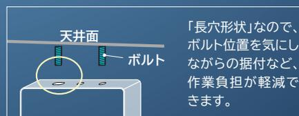
「長穴形状」なので、ボルト位置を気にしながらの据付など、作業負担が軽減できます。
