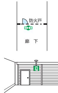
避難口から最も近い通路誘導灯
