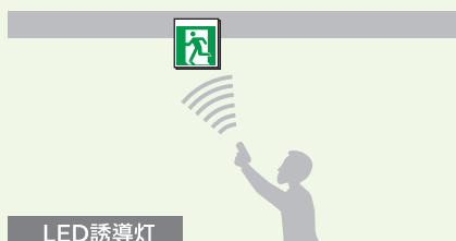
リモコン操作で自動点検をスタート。ラクラク点検が可能です。
