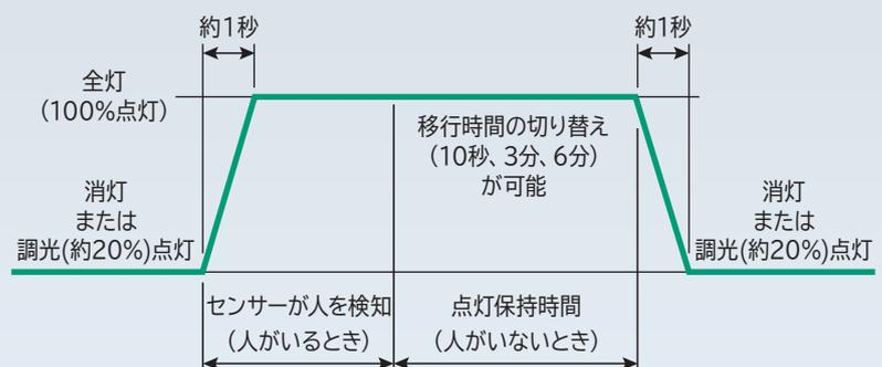
\*電源を入れた後の約30秒間、センサーは動作しません(LED光源ユニットは100%点灯します)。
