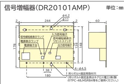
●増幅器の直列接続は3段まで(信号線短絡時は、短絡のあった回路の増幅器およびこれより上位の増幅器の信号線短絡表示ランプが点灯します)
