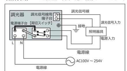
接続台数はスイッチから器具電源をとるスイッチ容量の制限による接続台数と信号制御用調光器の最大接続台数(50台)のどちらか少ない方の接続可能台数となります。電源スイッチの電流容量は15Aまでですが、安全を考慮し10.5Aで計算してください。
