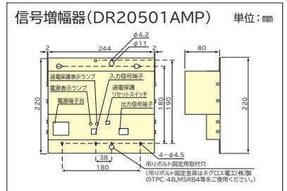
●増幅器の直列接続は3段まで(信号線短絡時は、短絡のあった回路の増幅器の過電流保護表示ランプが点灯します)
