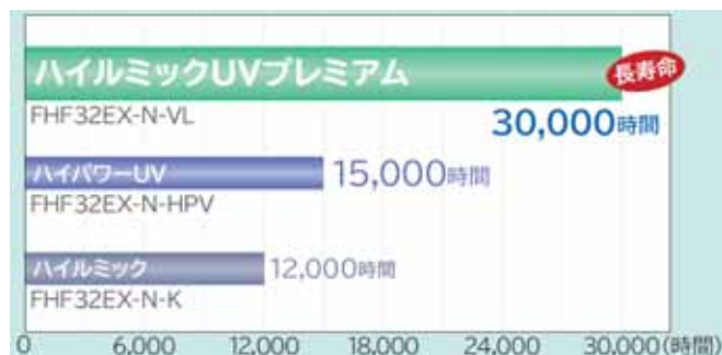
図 2. 当社高周波点灯専用形蛍光ランプ (Hf32 形) 定格寿命比較
