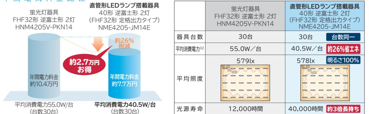
**試算条件** 建物規模(日立基準): 14.4m×10.8m(155.5㎡) 天井高さ2.7m(机上面0.75m) 反射率:天井50%、壁30%、床10%
