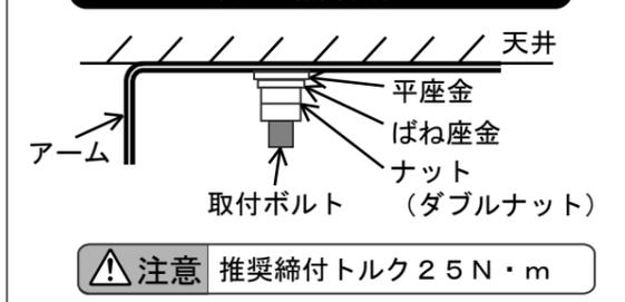
図3 傾斜天井に取り付ける場合
