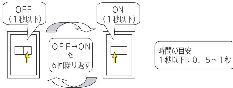
解除操作後、明るさが変化しない場合は、照度補正機能の解除が正しく行われていません。再度、解除操作を行ってください。
