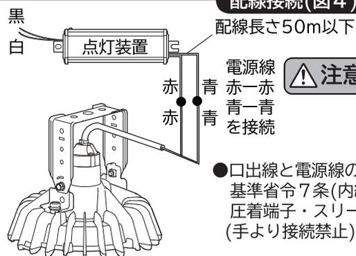
**注意** 適合点灯装置を使用する
