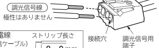
適合電線 CPEV (通信ケーブル)  $\phi 0.9 \sim \phi 1.2$  の単線
