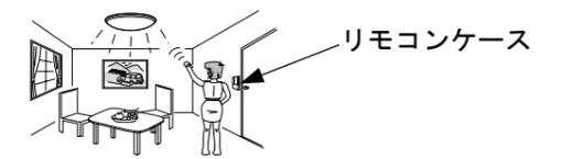
リモコンを使用するときは、リモコンケースから取り出し、器具に向けて操作してください。
