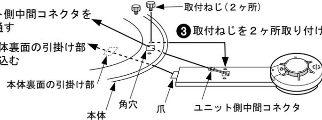
**必ず守る** 確実に取付ねじで取り付ける。
