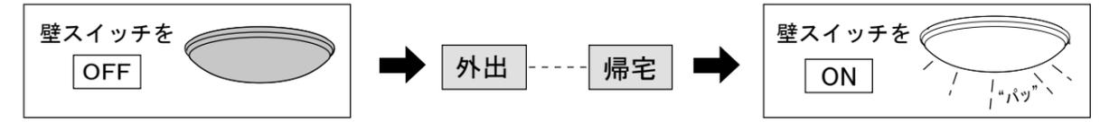
●壁スイッチを操作することで次の点灯モードに切り替えることができます。
