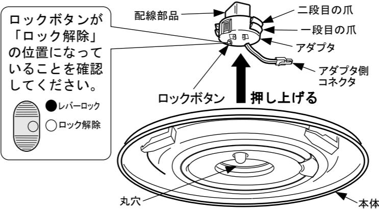
必ず守る 天井に付いている配線部品により、本体に掛かる爪の位置が変わるので必ず下図を参考し、適切な爪（両側2ヶ所）が本体に掛かっていることを確認する。
