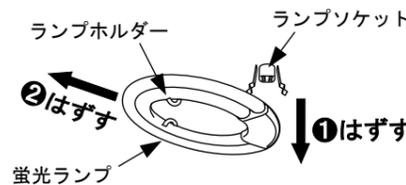
④交換用蛍光灯をランプホルダーに引っ掛け、口金をランプソケットに差し込んで取り付けてください。
