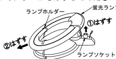
③はずすときと逆の順序で交換用蛍光ランプを取り付け、セードを本体に取り付けてください。
