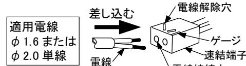
\* 電線を解除する場合は、電線解除穴にマイナスドライバーなどを差し込み、押しながら電線を引き抜いてください。
