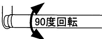
②蛍光ランプの両端のピンを、ランプソケットの溝からはずしてください。
