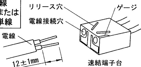
\*電線を解除する場合には、リリース穴にマイナスドライバーなどを差し込み、押しながら電線を引き抜いてください。
