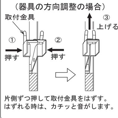
片側ずつ押して取付金具をはずす。はずれる時は、カチッと音がします。
