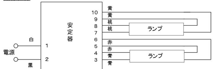
注) 電源線の白線は必ず電源の低圧側に接続してください。
