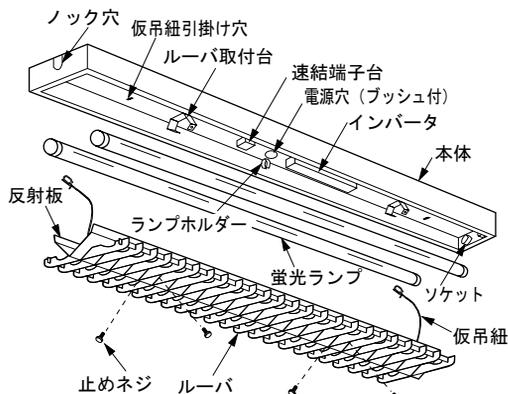
1. 本体の電源穴(ブッシュ付)より、電源線・アース線・調光信号線を引き込む。
