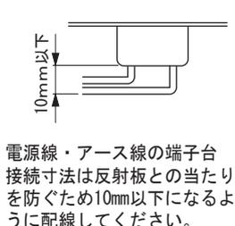
レースウェイ取付時の取付寸法・電源接続方向 (図3)
