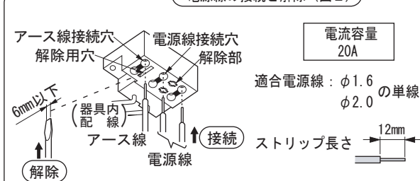
電源線の接続と解除（図2）
